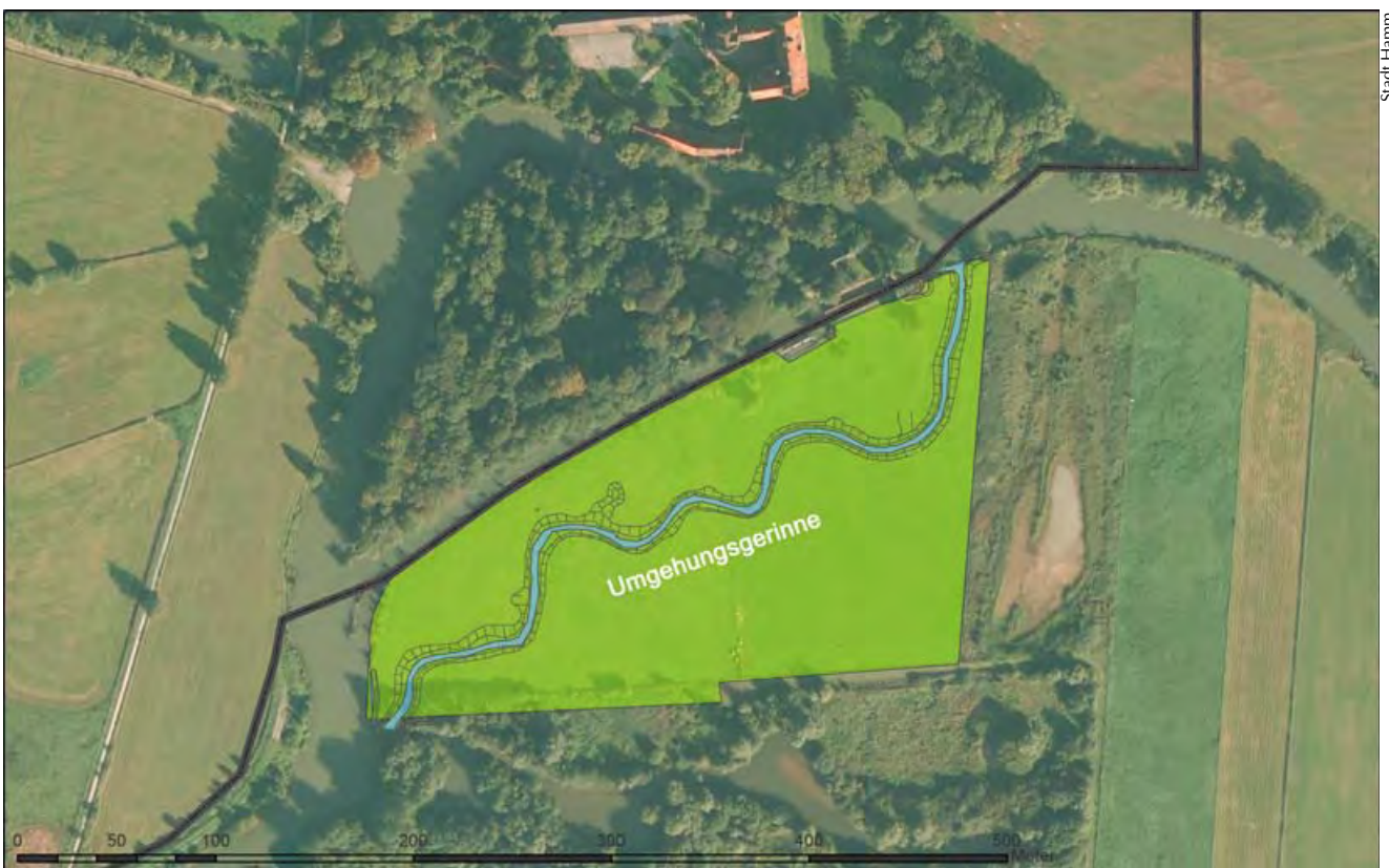
Maßnahmenblock A, in dem die „Umleitung“ - ein so genanntes Umgehungsgerinne - um das Wehr Heessen gebaut wurde, liegt südlich von Schloss Heessen.
