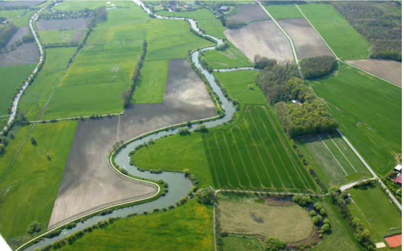
Maßnahmenblock C vor der Umgestaltung: Links der Lippe verläuft ein Weg auf dem befestigten Ufer, in der Aue liegen noch Äcker, Stillgewässer fehlen weitgehend.
