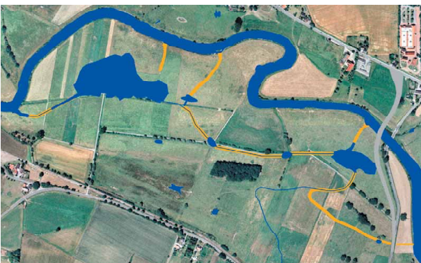
Links: Abfluss = 40 m 3 /s; die Rinnen sind nicht aktiv. Rechts: Abfluss=60 m 3 /s mit Geschwindigkeitspfeilen; die Rinnen sind aktiv.
