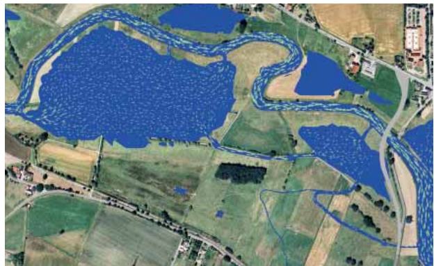
Links: Abfluss = 40 m 3 /s; die Rinnen sind nicht aktiv. Rechts: Abfluss=60 m 3 /s mit Geschwindigkeitspfeilen; die Rinnen sind aktiv.
